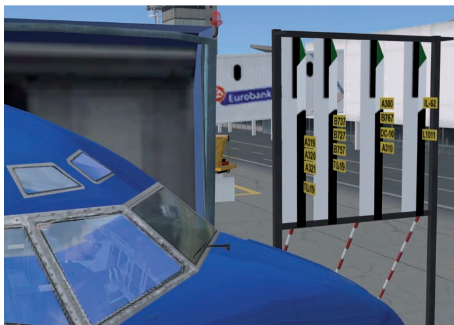
Helfen beim "Bremsen auf dem Punkt": Die selten gewordenen Side Marker Boards (SMB).
